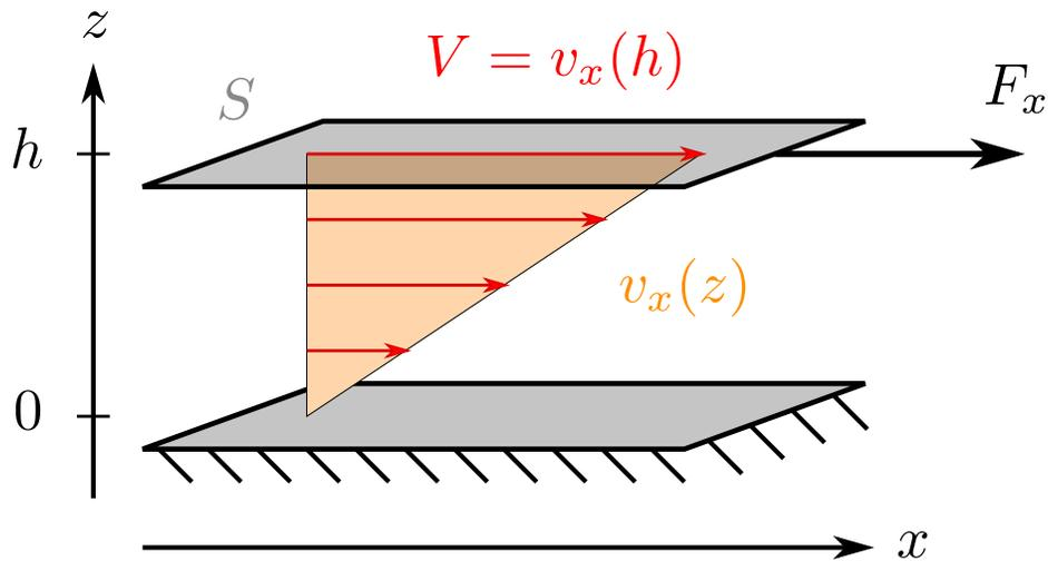
FIGURE 1 – *Ecoulement de Couette plan*
