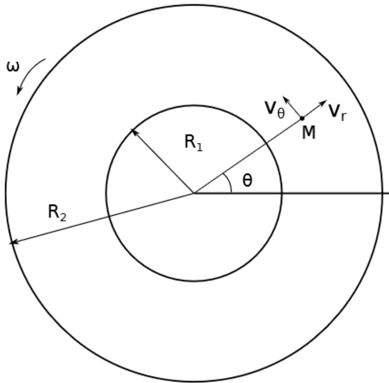
FIGURE 6 – *Ecoulement de Couette cylindrique*
