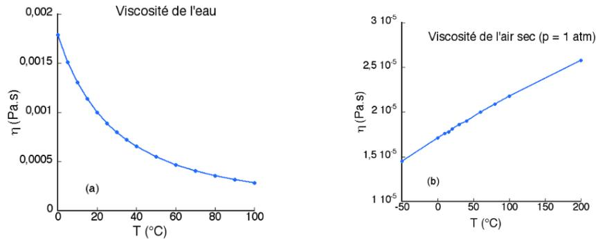
FIGURE 4 – Viscosité gaz/liquide
