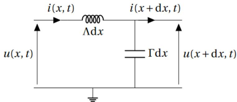
FIGURE 3 – Modèle sans perte du câble coaxiale
