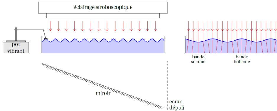
FIGURE 1 – Montage pour mesure de la relation de dispersion d’ondes de surface. Issus du fascicule de TP
