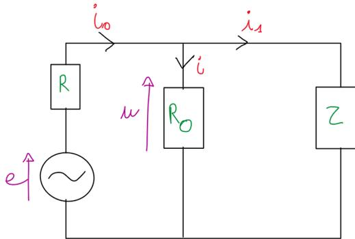
FIGURE 3 – Probleme de chute de tension
