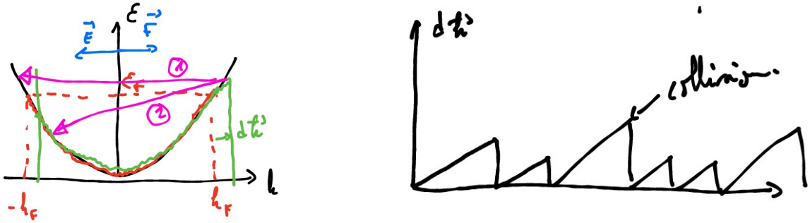
FIGURE 19 – Sur la figure de gauche : lorsque l’on applique un champ \mathbf{E} on crée une force \mathbf{F} dans le sens opposé. Le nuage électronique va alors peupler des états de haut vecteur d’onde en dépeuplant des états de faible vecteur d’onde. Les collisions ((1) = élastique ; (2) = inélastique) dépeuple les états excités pour repeupler les états de faible vecteur d’onde. Sur la figure de droite : plus \|\mathbf{k}\| augmente plus la probabilité qu’il y ait une collision est grande.
