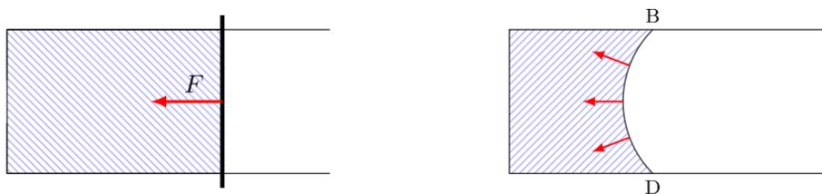
FIGURE 1.1 – À gauche, force de tension superficielle sur un barreau mobile. À droite, fil tendu par les forces de tension superficielle.
