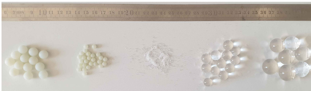
FIGURE 2 – Billes utilisées pour les suspensions. De gauche à droite : PA10, PA5, PS500, H10, H17.
