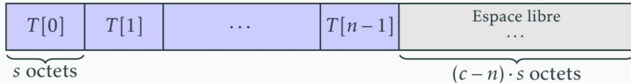
Si  $c > n$ , ajouter un élément ne nécessite pas de réallocation et donc pas de copie.
