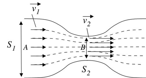
★ Pour cet écoulement homogène et incompressible, le vecteur vitesse est à flux conservatif :  $S_1 v_1 = S_2 v_2$ .
