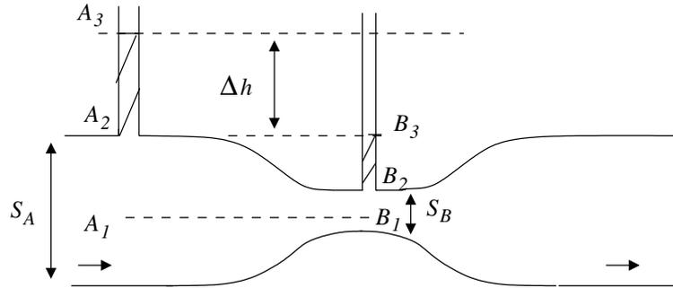
→ L'application de la relation de Bernoulli sur la ligne de courant entre  $A_1$  et  $B_1$  conduit à :
