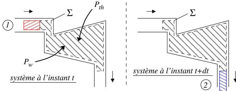
Pour ce système fermé, on applique le premier principe de la thermodynamique entre les instants  $t$  et  $t + dt$  :
