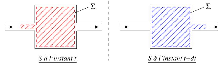
On s'intéresse à une grandeur extensive  $\mathcal{A}$  décrivant le fluide (quantité de mouvement, énergie cinétique, énergie mécanique, enthalpie, entropie,...)
