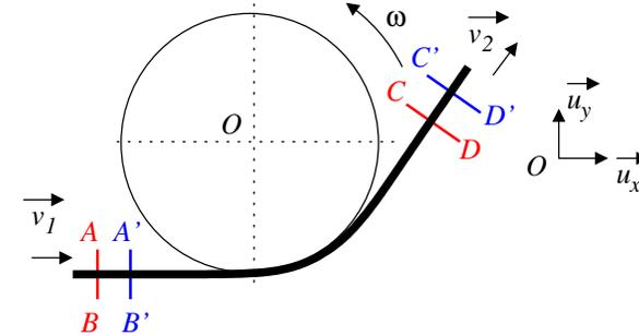
★ La turbine, modélisée par un disque de rayon  $a$  et de moment d'inertie  $J$ , tourne autour de l'axe  $\Delta$  à la vitesse angulaire  $\omega$  constante.
