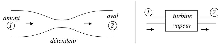
Au sein du détendeur, le fluide ne reçoit ni transfert thermique ni travail mécanique utile. Pour une machine réfrigérante, il semble raisonnable de ne pas tenir compte des variations d'énergie cinétique et potentielle, on en déduit :
