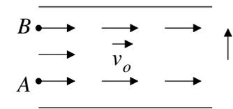
Justification : le fluide se déplaçant en bloc à la vitesse  $\vec{v}_0$ , l'idée est de se placer dans le référentiel du fluide dans lequel le fluide est au repos, on peut alors appliquer la loi de la statique des fluides.
