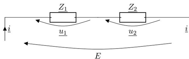
On veut calculer la tension  $\underline{u}_1$  aux bornes du dipôle d'impédance  $\underline{Z}_1$  en connaissant la tension  $\underline{E}$  aux bornes de deux dipôles en série. Pour cela, on écrit la loi des mailles :
