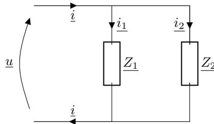
On veut calculer l'intensité  $\underline{i}_1$  traversant le dipôle d'impédance  $\underline{Z}_1$  en connaissant l'intensité  $\underline{i}$  qui sera répartie entre les dipôles en parallèle. Pour cela, on utilise la loi des noeuds :
