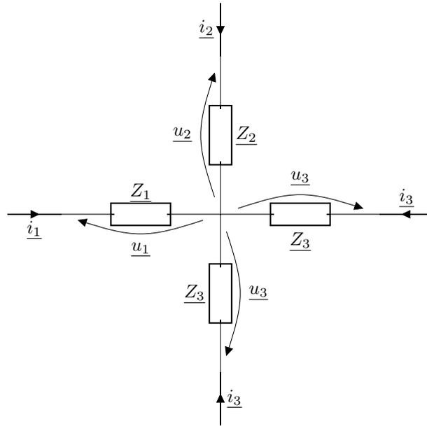
Prenons un noeud sur lequel sont branchés 4 dipôles d'impédance  $Z_k$ . Notons  $V_{\text{noeud}}$  le potentiel du noeud et  $V_k$  le potentiel au bout de la branche  $k$ . La tension aux bornes du dipôle de la branche  $k$  est  $u_k = V_k - V_{\text{noeud}}$ . Chaque branche est parcourue par une intensité  $i_k$ .
