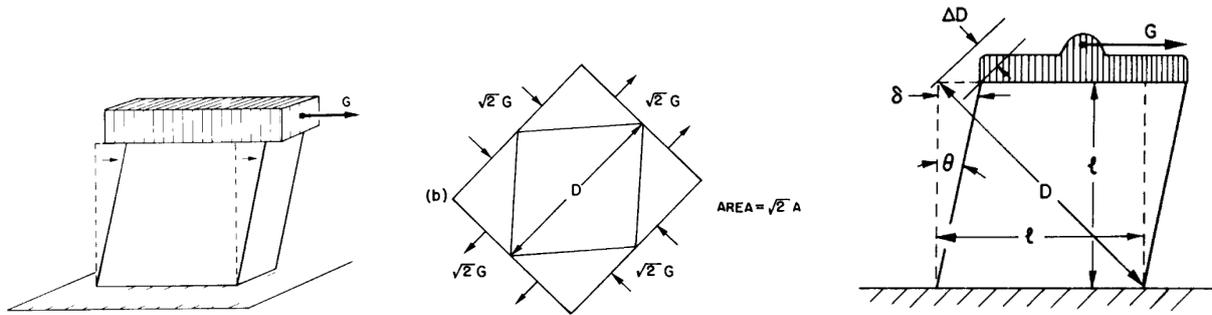
FIGURE 2 – Un cube sous cisaillement uniforme.
